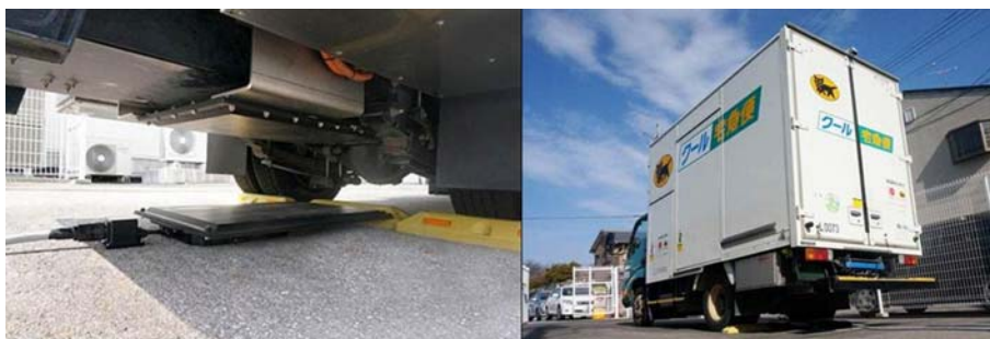
<図-9 非接触充電システム製作・設置完>
