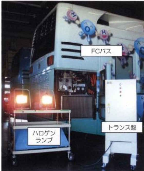
写真 II - 1. 小容量での現 FC バスからの V2H 通電動作確認
