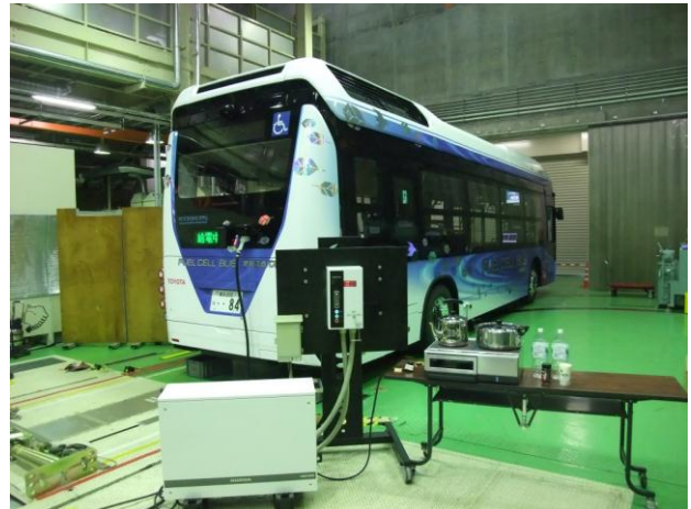
写真Ⅳ－ 2. H 社製給電器との互換性試験
