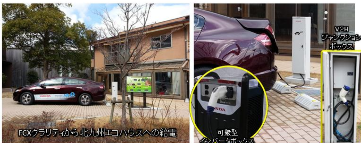
図1. 燃料電池電気自動車からのV2H実証試験
